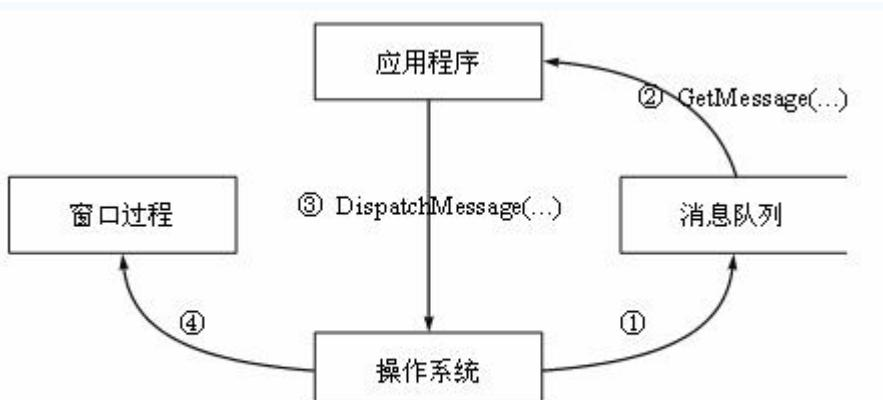
图 1.2 Windows 应用程序的消息处理机制
